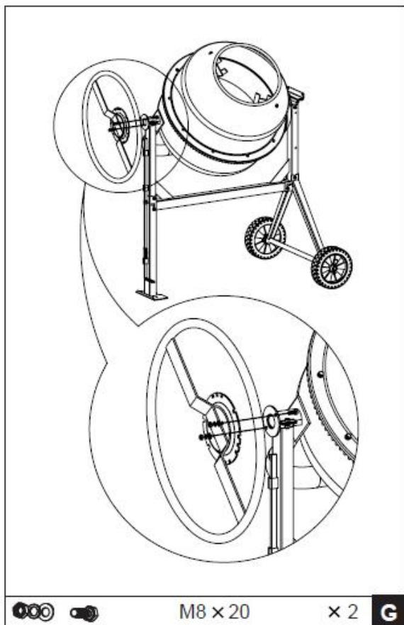
Installez la roue de basculement avec plaque de verrouillage sur la bride du cadre avec deux boulons hexagonaux M8X20 chacun avec une rondelle plate, une rondelle frein et un écrou.
