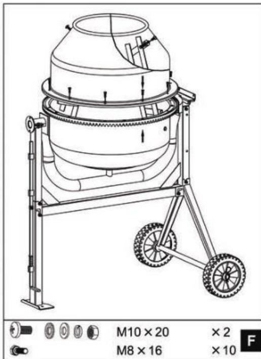
1. Positionnez le tambour supérieur sur le tambour inférieur au-dessus de la jante, en vous assurant que les trous de montage sont alignés sur les deux ainsi que sur les flèches étiquetées.
