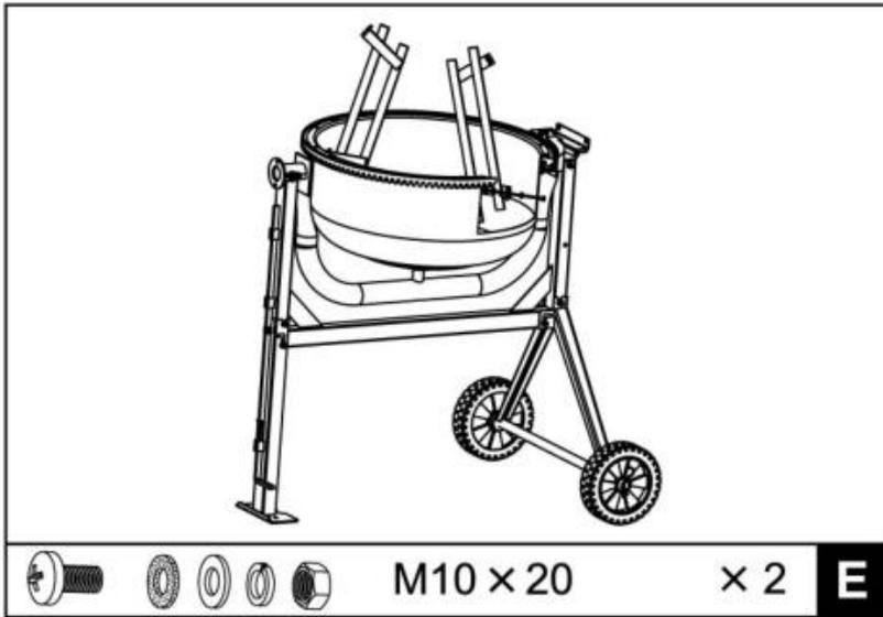
Montez les lames de mélange à l'intérieur du tambour inférieur sans le serrer comme illustré - Deux trous sont prévus à la base du tambour dans lesquels une vis à tête cruciforme M10X20 peut être insérée de l'extérieur.
