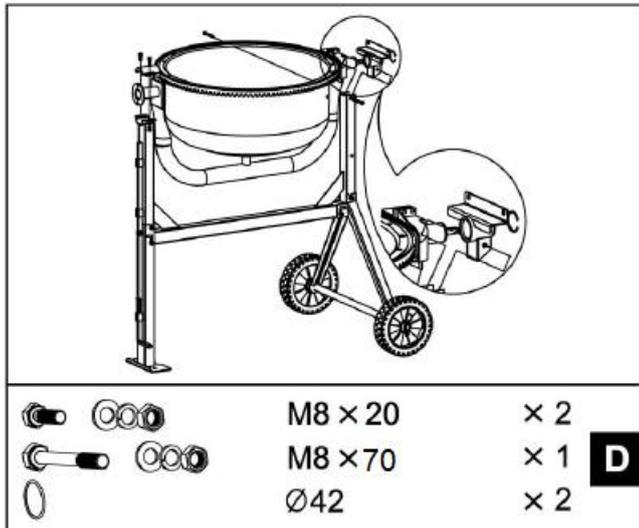
1. Faites glisser le bloc de roulement sur l'arbre. Insérez les anneaux Ø42.
