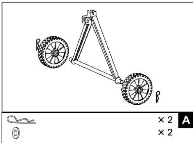
1. Faites glisser les roues sur les deux côtés de l'essieu. Fixez avec des attaches en épingle (x2) et des rondelles plates (x2).
