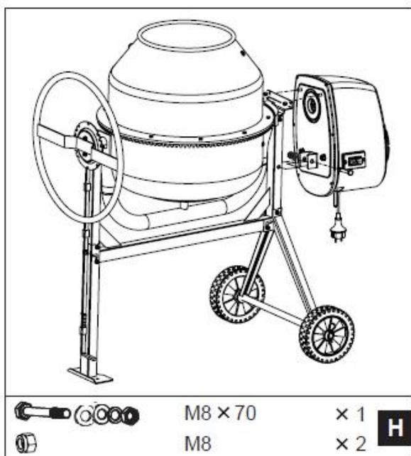
En alignant les rainures, faites glisser le carter de transmission sur l'arbre de pignon. Vissez un écrou avec une rondelle plate sur chaque boulon à tige. Fixez le support de boîtier inférieur au cadre de support latéral en insérant un M8X70 d'un côté, puis une rondelle plate, une rondelle frein et un écrou de l'autre côté.
