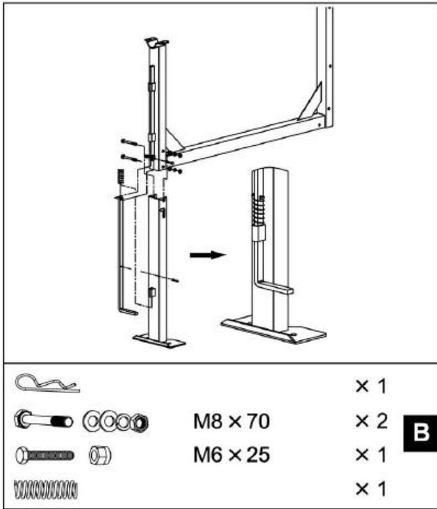
2. Le cadre étant sur le côté, fixez le pied de support comme illustré. Insérez deux boulons hexagonaux M8X70 dans les trous d'un côté, puis des rondelles plates, des rondelles de blocage et des écrous de l'autre côté. Faites glisser le ressort sur la tige de piston inférieure. Connectez les tiges de piston avec un boulon hexagonal M6X25 et un écrou. Maintenez le ressort en place en insérant une goupille fendue. Pliez chaque côté de la broche vers l'extérieur. Resserrez.
